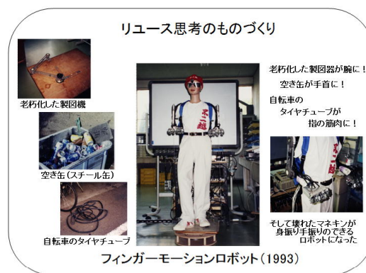
図1 リユース思考によるロボットの製作例
