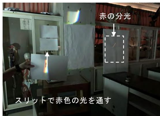
写真3 プリズムで分光した光のうちスリットで赤色の光をもう一つにプリズムに入射させても、分光は赤のまま変わらない。
